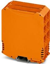
Tragschienengehäuse, Komplettgehäuse mit Metallfußriegel, hohe Bauform, mit Lüftungsschlitzen, Breite: 45,2 mm, Höhe: 99 mm, Tiefe: 113,65 mm, Farbe: lichtgrau (ähnlich RAL 7035), Querverbindung: Tragschienen-Busverbinder (optional), Polzahl Querverbinder: 5
