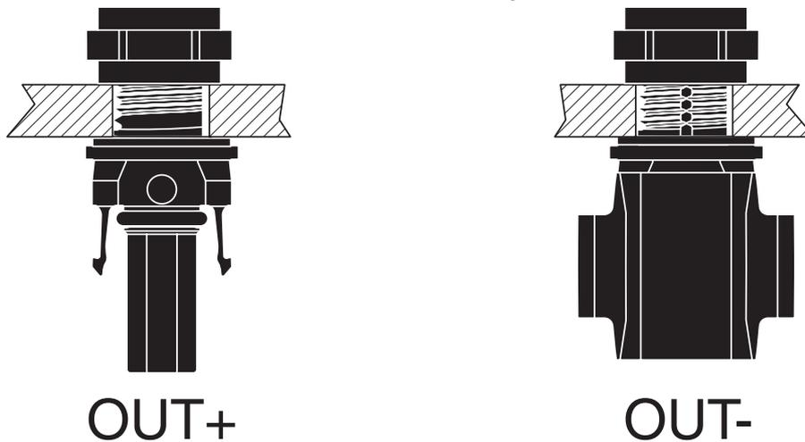
Anschluss zum Wechselrichter
