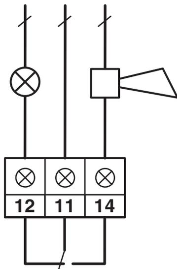
Anschluss des Fernmeldekonzakts am Überspannungsschutz
