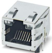
RJ45-Leiterplatten-Steckverbinder, Bauform: RJ45, Polzahl: 8, 10 GBit/s, THR-Löten, Schutzart: IP20, Anschlussart: THR-Reflow / THT-Welle, Tape and Reel
