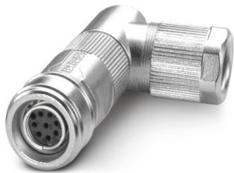
Steckverbinder, Universal, 8-polig, geschirmt, Buchse gewinkelt M12 Push-Pull, Kodierung: A, Crimpanschluss, Rändelmaterial: Zinkdruckguss, vernickelt, Leitungsaußendurchmesser 4,5 mm ... 7,5 mm, ohne Crimpkontakte
