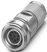
Steckverbinder, Universal, 8-polig, geschirmt, Buchse gerade M12 Push-Pull, Kodierung: A, Crimpanschluss, Rändelmaterial: Zinkdruckguss, vernickelt, Leitungsaußendurchmesser 4,5 mm ... 7,5 mm, ohne Crimpkontakte
