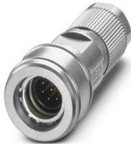
Steckverbinder, Universal, 8-polig, geschirmt, Stecker gerade M12 Push-Pull-Außenverriegelung, Kodierung: A, Crimpanschluss, Rändelmaterial: PA 6.6, Leitungsaußendurchmesser 4,5 mm ... 7,5 mm, ohne Crimpkontakte
