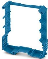
Tragschienengehäuse, Zwischenelement, hohe Bauform, mit Lüftungsschlitzen, Breite: 22,6 mm, Höhe: 99 mm, Tiefe: 112,85 mm, Farbe: blau (ähnlich RAL 5015)
