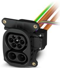
CHARX connect universal, DC CCS Typ 2, Fahrzeug-Ladedose, bis zu 500 A im Boost Mode, 250 A dauerhaft, 1000 V DC, Einzeladern, Länge: 3 m, Verriegelungsaktuator: 12 V, 4-polig, Vorder- und Rückwandmontage, M6, Gehäuse: schwarz, zum Laden mit Gleichstrom (DC), IEC 62196-2, IEC 62196-3, Für die DC-Kontakte ist eine Schutzkappe im Lieferumfang enthalten.
