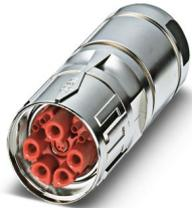
M40, Kupplungssteckverbinder, Serie: SB, gerade lang, geschirmt: ja, für Standard- und SPEEDCON-Verriegelung, Polzahl: 4+4+PE / 3+N+PE, Kontaktart: Buchse, Crimpanschluss, Kabeldurchmesserbereich: 20,5 mm ... 26,5 mm, Kodierung: Signal, Kodierung 1, dieser Artikel ist voraussichtlich ab 2025-Q3 nach RoHS II ohne Ausnahme 6c (Pb < 0,1 %) bleifrei, auf Anfrage ist eine bleifreie Alternative vorab möglich
