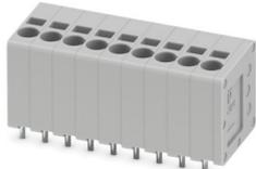
Leiterplattenklemme, Nennstrom: 17,5 A, Bemessungsspannung (III/2): 200 V, Nennquerschnitt: 1,5 mm<sup>2</sup>, Anzahl der Reihen: 1, Polzahl pro Reihe: 9, Artikelfamilie: SPT 1,5/..-V, Rastermaß: 3,5 mm, Anschlussart: Push-in-Federanschluss, Montage: Wellenlöten, Anschlussrichtung Leiter/Platine: 90 °, Farbe: grau, Pin-Layout: Lineares Pinning, Pinlänge [P]: 2,5 mm, Anzahl der Lötpins pro Potenzial: 2, Verpackungsart: verpackt im Karton
