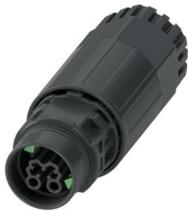
Kupplungssteckverbinder, Artikelfamilie: PRC 20, Farbe: schwarz, Polzahl: 2, Aderquerschnitt min.: 0,5 mm<sup>2</sup>, Aderquerschnitt max.: 2,5 mm<sup>2</sup>, Bemessungsspannung: 400 V, Bemessungsstrom: 20 A, Anschlussart: Schraubanschluss, Einstellmöglichkeit für die Entriegelung: 1. mit einem Werkzeug oder 2. von Hand, Anwendungsbereich: BUS
