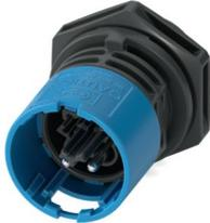
Gerätesteckverbinder Vorderwand, Artikelfamilie: PRC 20, Farbe: schwarz, Polzahl: 2, Aderquerschnitt min.: 0,5 mm<sup>2</sup>, Aderquerschnitt max.: 2,5 mm<sup>2</sup>, Bemessungsspannung: 400 V, Bemessungsstrom: 20 A, Anschlussart: Schraubanschluss, Einstellmöglichkeit für die Entriegelung: 1. mit einem Werkzeug oder 2. von Hand, Anwendungsbereich: AC
