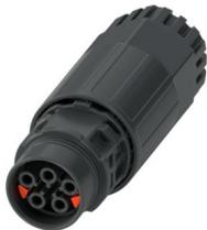
Kupplungssteckverbinder, Artikelfamilie: PRC 20, Farbe: schwarz, Polzahl: 5, Aderquerschnitt min.: 0,5 mm<sup>2</sup>, Aderquerschnitt max.: 2,5 mm<sup>2</sup>, Bemessungsspannung: 400 V, Bemessungsstrom: 20 A, Anschlussart: Schraubanschluss, Kabeldurchmesser min.: 8 mm, Kabeldurchmesser max.: 14 mm, Einstellmöglichkeit für die Entriegelung: 1. mit einem Werkzeug oder 2. von Hand, Anwendungsbereich: AC
