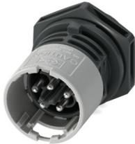
Gerätesteckverbinder Vorderwand, Artikelfamilie: PRC 20, Farbe: schwarz, Polzahl: 5, Aderquerschnitt min.: 0,5 mm<sup>2</sup>, Aderquerschnitt max.: 2,5 mm<sup>2</sup>, Bemessungsspannung: 400 V, Bemessungsstrom: 20 A, Anschlussart: Schraubanschluss, Einstellmöglichkeit für die Entriegelung: 1. mit einem Werkzeug oder 2. von Hand, Anwendungsbereich: DALI
