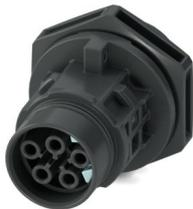
Gerätesteckverbinder Vorderwand, Artikelfamilie: PRC 20, Farbe: schwarz, Polzahl: 5, Aderquerschnitt min.: 0,5 mm<sup>2</sup>, Aderquerschnitt max.: 2,5 mm<sup>2</sup>, Bemessungsspannung: 400 V, Bemessungsstrom: 20 A, Anschlussart: Schraubanschluss, Einstellmöglichkeit für die Entriegelung: 1. mit einem Werkzeug oder 2. von Hand, Anwendungsbereich: SIGNAL
