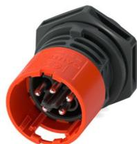
Gerätesteckverbinder Vorderwand, Artikelfamilie: PRC 20, Farbe: schwarz, Polzahl: 5, Aderquerschnitt min.: 0,5 mm<sup>2</sup>, Aderquerschnitt max.: 2,5 mm<sup>2</sup>, Bemessungsspannung: 400 V, Bemessungsstrom: 20 A, Anschlussart: Schraubanschluss, Einstellmöglichkeit für die Entriegelung: 1. mit einem Werkzeug oder 2. von Hand, Anwendungsbereich: AC
