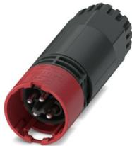
Steckverbinder, Artikelfamilie: PRC 20, Farbe: schwarz, Polzahl: 4, Aderquerschnitt min.: 0,5 mm<sup>2</sup>, Aderquerschnitt max.: 2,5 mm<sup>2</sup>, Bemessungsspannung: 400 V, Bemessungsstrom: 20 A, Anschlussart: Schraubanschluss, Einstellmöglichkeit für die Entriegelung: 1. mit einem Werkzeug oder 2. von Hand, Anwendungsbereich: AC
