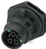
Gerätesteckverbinder Vorderwand, Artikelfamilie: PRC 20, Farbe: schwarz, Polzahl: 4, Aderquerschnitt min.: 0,5 mm<sup>2</sup>, Aderquerschnitt max.: 2,5 mm<sup>2</sup>, Bemessungsspannung: 400 V, Bemessungsstrom: 20 A, Anschlussart: Schraubanschluss, Einstellmöglichkeit für die Entriegelung: 1. mit einem Werkzeug oder 2. von Hand, Anwendungsbereich: BUS
