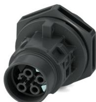
Gerätesteckverbinder Vorderwand, Artikelfamilie: PRC 20, Farbe: schwarz, Polzahl: 4, Aderquerschnitt min.: 0,5 mm<sup>2</sup>, Aderquerschnitt max.: 2,5 mm<sup>2</sup>, Bemessungsspannung: 400 V, Bemessungsstrom: 20 A, Anschlussart: Schraubanschluss, Einstellmöglichkeit für die Entriegelung: 1. mit einem Werkzeug oder 2. von Hand, Anwendungsbereich: SIGNAL
