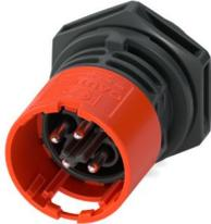
Gerätesteckverbinder Vorderwand, Artikelfamilie: PRC 20, Farbe: schwarz, Polzahl: 4, Aderquerschnitt min.: 0,5 mm<sup>2</sup>, Aderquerschnitt max.: 2,5 mm<sup>2</sup>, Bemessungsspannung: 400 V, Bemessungsstrom: 20 A, Anschlussart: Schraubanschluss, Einstellmöglichkeit für die Entriegelung: 1. mit einem Werkzeug oder 2. von Hand, Anwendungsbereich: AC
