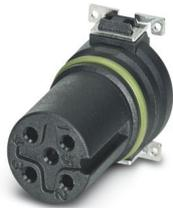
Kontaktträger, 4-polig, Buchse, gerade, M12, A-Kodierung, SMD-Reflow, Artikel ist bleifrei nach RoHS II ohne Ausnahme 6c (Pb < 0,1 %)
