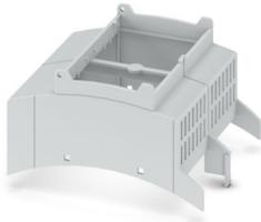
Tragschienengehäuse für den Einsatz in Installationsverteilern nach DIN 43880, modulares Gehäuseoberteil, Breite: 71,6 mm, Höhe: 89,7 mm, Tiefe: 54,85 mm, Farbe: lichtgrau (ähnlich RAL 7035)
