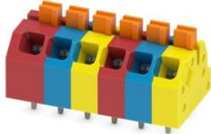
Leiterplattenklemme, Nennstrom: 16 A, Bemessungsspannung (III/2): 160 V, Nennquerschnitt: 1,5 mm<sup>2</sup>, Anzahl der Reihen: 1, Polzahl pro Reihe: 6, Artikelfamilie: SPTAF 1/..-EL, Rastermaß: 3,5 mm, Anschlussart: Push-in-Federanschluss, Montage: Wellenlöten, Anschlussrichtung Leiter/Platine: 45 °, Farbe: mehrfarbig, Pin-Layout: Lineares Pinning, Pinlänge [P]: 2,6 mm, Anzahl der Lötpins pro Potenzial: 2, Verpackungsart: verpackt im Karton
