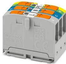
Geräteklemme, Nennspannung: 450 V, Nennstrom: 24 A, Anzahl der Anschlüsse: 6, Polzahl: 3, Anschlussart: Push-in-Anschluss, Querschnitt: 0,14 mm<sup>2</sup> - 4 mm<sup>2</sup>, Montageart: aufrasten auf Tragschienenadapter, Direktmontage mit Flansch, Fliegend, Farbe: grau/blau/grün-gelb
