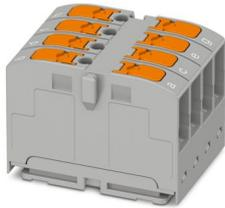
Geräteklemme, Nennspannung: 450 V, Nennstrom: 24 A, Anzahl der Anschlüsse: 8, Polzahl: 4, Anschlussart: Push-in-Anschluss, Querschnitt: 0,14 mm<sup>2</sup> - 4 mm<sup>2</sup>, Push-in-Anschluss, Bemessungsquerschnitt: 2,5 mm<sup>2</sup>, Montageart: aufrasten auf Tragschienenadapter, Direktmontage mit Flansch, Fliegend, Farbe: grau
