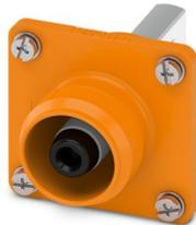
Steckverbinder, Artikelfamilie: BPC, Farbe: orange, Polzahl: 1, Aderquerschnitt min.: 95 mm<sup>2</sup>, Aderquerschnitt max.: 120 mm<sup>2</sup>, Bemessungsspannung: 1500, Bemessungsstrom: 350 A, Anschlussart: Schraub-/Lötanschluss
