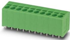
Leiterplattenklemme, Nennstrom: 22 A, Nennquerschnitt: 2,5 mm<sup>2</sup>, Anzahl der Reihen: 1, Polzahl pro Reihe: 7, Artikelfamilie: SPT 2,5/..-V-EX, Rastermaß: 5 mm, Anschlussart: Push-in-Federanschluss, Montage: Wellenlöten, Anschlussrichtung Leiter/Platine: 90 °, Farbe: mehrfarbig, Pin-Layout: Lineares Pinning, Pinlänge [P]: 2,5 mm, Anzahl der Lötpins pro Potenzial: 2, Verpackungsart: verpackt im Karton
