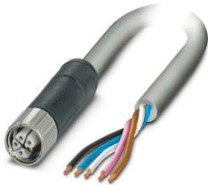
Powerleitung, 5-polig, PUR halogenfrei, grau RAL 7001, freies Leitungsende, auf Buchse gerade M12, Kodierung: L, Kabellänge: 20 m, für Gleichstrom bis 16 A / 63 V
