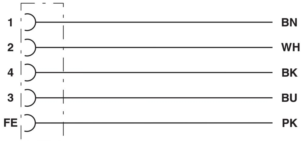
Kontaktbelegung der M12-Buchse
