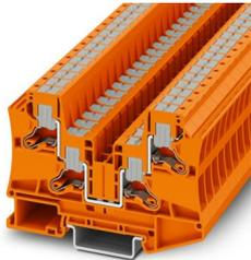
Durchgangsklemme, Nennspannung: 1000 V, Nennstrom: 41 A, Anzahl der Anschlüsse: 4, Polzahl: 1, Anschlussart: Push-in-Anschluss, Bemessungsquerschnitt: 6 mm<sup>2</sup>, Querschnitt: 0,5 mm<sup>2</sup> - 10 mm<sup>2</sup>, Montageart: NS 35/7,5, NS 35/15, Farbe: orange
