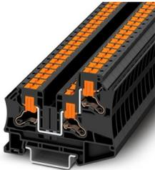
Durchgangsklemme, Nennspannung: 1000 V, Nennstrom: 41 A, Anzahl der Anschlüsse: 3, Polzahl: 1, Anschlussart: Push-in-Anschluss, Bemessungsquerschnitt: 6 mm<sup>2</sup>, Querschnitt: 0,5 mm<sup>2</sup> - 10 mm<sup>2</sup>, Montageart: NS 35/7,5, NS 35/15, Farbe: schwarz
