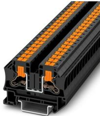
Durchgangsklemme, Nennspannung: 1000 V, Nennstrom: 41 A, Anzahl der Anschlüsse: 2, Polzahl: 1, Anschlussart: Push-in-Anschluss, Bemessungsquerschnitt: 6 mm<sup>2</sup>, Querschnitt: 0,5 mm<sup>2</sup> - 10 mm<sup>2</sup>, Montageart: NS 35/7,5, NS 35/15, Farbe: schwarz
