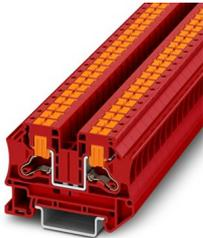
Durchgangsklemme, Nennspannung: 1000 V, Nennstrom: 41 A, Anzahl der Anschlüsse: 2, Polzahl: 1, Anschlussart: Push-in-Anschluss, Bemessungsquerschnitt: 6 mm<sup>2</sup>, Querschnitt: 0,5 mm<sup>2</sup> - 10 mm<sup>2</sup>, Montageart: NS 35/7,5, NS 35/15, Farbe: rot
