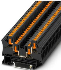
Durchgangsklemme, Nennspannung: 1000 V, Nennstrom: 32 A, Anzahl der Anschlüsse: 4, Anschlussart: Push-in-Anschluss, Bemessungsquerschnitt: 4 mm<sup>2</sup>, Querschnitt: 0,2 mm<sup>2</sup> - 6 mm<sup>2</sup>, Montageart: NS 35/7,5, NS 35/15, Farbe: schwarz
