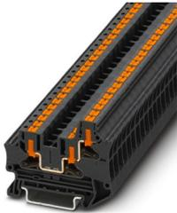
Durchgangsklemme, Nennspannung: 1000 V, Nennstrom: 32 A, Anzahl der Anschlüsse: 3, Anschlussart: Push-in-Anschluss, Bemessungsquerschnitt: 4 mm<sup>2</sup>, Querschnitt: 0,2 mm<sup>2</sup> - 6 mm<sup>2</sup>, Montageart: NS 35/7,5, NS 35/15, Farbe: schwarz
