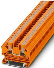
Durchgangsklemme, Nennspannung: 1000 V, Nennstrom: 32 A, Anzahl der Anschlüsse: 2, Anschlussart: Push-in-Anschluss, Bemessungsquerschnitt: 4 mm<sup>2</sup>, Querschnitt: 0,2 mm<sup>2</sup> - 6 mm<sup>2</sup>, Montageart: NS 35/7,5, NS 35/15, Farbe: orange
