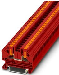
Durchgangsklemme, Nennspannung: 1000 V, Nennstrom: 32 A, Anzahl der Anschlüsse: 2, Anschlussart: Push-in-Anschluss, Bemessungsquerschnitt: 4 mm<sup>2</sup>, Querschnitt: 0,2 mm<sup>2</sup> - 6 mm<sup>2</sup>, Montageart: NS 35/7,5, NS 35/15, Farbe: rot
