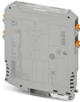
Elektronisches Wendelastrelais, zur Ansteuerung von DC-Motoren, mit Leuchtanzeige und Schutzbeschaltung, Ausgang: 24 V DC/10 A mit einer Umschaltzeit von 5 ms
