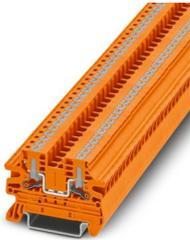
Durchgangsklemme, Nennspannung: 800 V, Nennstrom: 24 A, Anzahl der Anschlüsse: 2, Polzahl: 1, Anschlussart: Push-in-Anschluss, Bemessungsquerschnitt: 2,5 mm<sup>2</sup>, Querschnitt: 0,14 mm<sup>2</sup> - 4 mm<sup>2</sup>, Montageart: NS 35/7,5, NS 35/15, Farbe: orange
