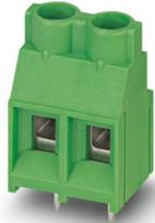
Leiterplattenklemme, Nennstrom: 32 A, Bemessungsspannung (III/2): 630 V, Nennquerschnitt: 4 mm<sup>2</sup>, Anzahl der Reihen: 1, Polzahl pro Reihe: 6, Artikelfamilie: MKDS 5, Rastermaß: 7,62 mm, Anschlussart: Schraubanschluss mit Zughülse, Schraubenangriffsform: L Längsschlitz, Montage: Wellenlöten, Anschlussrichtung Leiter/Platine: 0 °, Farbe: grün, Pin-Layout: Lineares Pinning, Pinlänge [P]: 5,1 mm, Anzahl der Lötpins pro Potenzial: 1, Verpackungsart: verpackt im Karton
