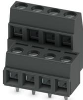
Leiterplattenklemme, Nennstrom: 13,5 A, Bemessungsspannung (III/2): 400 V, Nennquerschnitt: 1,5 mm<sup>2</sup>, Anzahl der Reihen: 2, Polzahl pro Reihe: 4, Artikelfamilie: MKKDSN 1,5, Rastermaß: 5 mm, Anschlussart: Schraubanschluss mit Zughülse, Schraubenangriffsform: L Längsschlitz, Montage: Wellenlöten, Anschlussrichtung Leiter/Platine: 0 °, Farbe: schwarz, Pin-Layout: Lineares Pinning, Pinlänge [P]: 3,5 mm, Anzahl der Löt pins pro Potenzial: 1, Verpackungsart: verpackt im Karton
