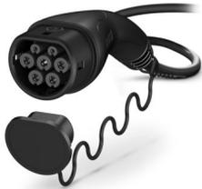
CHARX connect eco, Typ 2, AC-Ladeleitung, 20 A dauerhaft, 480 V AC, mit Fahrzeug-Ladestecker und offenem Leitungsende, Kabel: 5 m, schwarz, gerade, mit Schutzkappe, PHOENIX CONTACT-Logo, IEC 62196-2, zum Laden mit Wechselstrom (AC) von Elektrofahrzeugen (EV)
