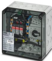
Generatoranschlusskasten für Photovoltaikanlagen bis 1000 V DC zum Anschluss von 1x 2 Strings. Mit Überspannungsschutz (Typ 1/2), DC-Lasttrennschalter und Kabelverschraubungen für die Eingangs- und Ausgangsseite.
