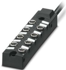
Verteilerbox, Anwendung: Standard Metall, Anzahl der Steckplätze: 8, Polzahl: 3, Kodierung: A, Steckplatzbelegung: einfach, Statusanzeige: ja; Stammleitungsanschluss: Festanschluss 180°, PUR/PVC, Leitungslänge: 2,5 m, Schirmung: nein
