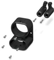
CHARX connect, CCS Typ 2, Reparatur-Kit, Zubehör, Gehäuse: schwarz, mit DC-Kontakthalterung mit integriertem vorderen Teil der DC-Kontakte, mit austauschbarem Steckgesichtrahmen, mit 5 Stück M4X10-Flachkopfschrauben mit Torx-Sicherheitsantrieb (IPR TORX PLUS®), für Austausch des Steckgesichtrahmens von Fahrzeug-Ladesteckern, IEC 62196-3-1, Austausch ohne Leeren der Kühlflüssigkeit
