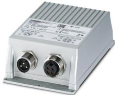
Primär getaktete Stromversorgung TRIO POWER, 7/8"-Rundsteckverbinder, Wandmontage, Eingang: 1-phasig, Ausgang: 24 V DC / 3,75 A
