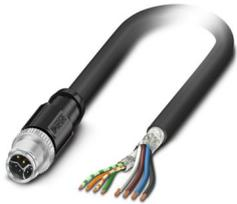
Hybridkabel, Ethernet Hybrid CAT5 (100 MBit/s), 8-polig, PUR halogenfrei, schwarz RAL 9005, geschirmt (Advanced Shielding Technology), Stecker gerade M12, Kodierung: Y / IP65/IP67, auf freies Leitungsende, Kabellänge: 10 m, Power with Ethernet (PWE)
