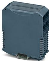
Tragschienengehäuse, Komplettgehäuse mit Metallfußriegel, hohe Bauform, mit Lüftungsschlitzen, Breite: 45,2 mm, Höhe: 99 mm, Tiefe: 113,65 mm, Farbe: blaugrau (ähnlich RAL 7031), Querverbindung: Tragschienen-Busverbinder (optional), Polzahl Querverbinder: 5
