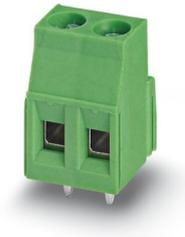
Leiterplattenklemme, Nennstrom: 24 A, Bemessungsspannung (III/2): 400 V, Nennquerschnitt: 2,5 mm<sup>2</sup>, Anzahl der Reihen: 1, Polzahl pro Reihe: 3, Artikelfamilie: MKDSN 2,5, Rastermaß: 5 mm, Anschlussart: Schraubanschluss mit Zughülse, Schraubenangriffsform: L Längsschlitz, Montage: Wellenlöten, Anschlussrichtung Leiter/Platine: 0 °, Farbe: grün, Pin-Layout: Lineares Pinning, Pinlänge [P]: 3,5 mm, Anzahl der Lötpins pro Potenzial: 1, Verpackungsart: verpackt im Karton
