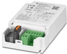
Lichtsteuergerät zum Ansteuern von LED-Treibern, Eingangsspannung 110 V ... 277 V, 2 Relaisausgänge, Laststrom 8 A, bis zu 8 LED-Treiber ansteuerbar, 10 V Analogschnittstelle, DALI-Schnittstelle, Messen der Lastströme
