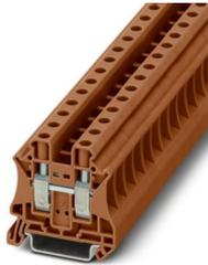
Durchgangsklemme, Nennspannung: 1000 V, Nennstrom: 57 A, Anzahl der Anschlüsse: 2, Anschlussart: Schraubanschluss, Bemessungsquerschnitt: 10 mm<sup>2</sup>, Querschnitt: 0,5 mm<sup>2</sup> - 16 mm<sup>2</sup>, Montageart: NS 35/7,5, NS 35/15, Farbe: braun
